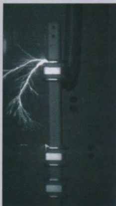
Hochgeschwindigkeitsaufnahme einer Funkenstrecke mit der pco.dimax. Es handelt sich hier um eine Materialprüfung beim Stab eines Wählers. Überraschenderweise erfolgte der Überschlag nicht an der zu erwartenden kürzesten Strecke zwischen den beiden geprüften Elektroden, sondern vom Kopf der Hochspannungselektrode ausgehend im Öl.
