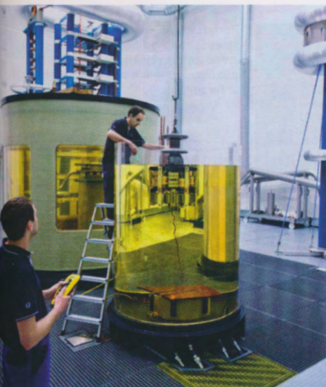
Halle für Hochspannungsprüfungen im Versuchszentrum Regensburg der Maschinenfabrik Reinhausen: Herunterlassen eines Prüflings in den mit Öl gefüllten Prüfbehälter
